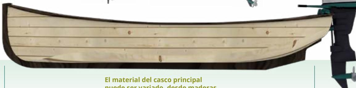
El material del casco principal puede ser variado, desde maderas con cubiertas protectoras, fibra de vidrio, polímeros gruesos o aleaciones metálicas
