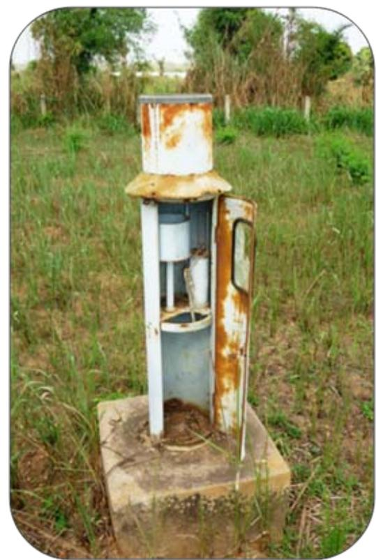
Figure 7.1 : Pluviomètre en panne
