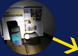
La lumière émise par 3 diodes est suffisante pour fournir de la lumière d'une intensité de 228 lux à 70cm de distance (Pour comparer, 200 lux sont nécessaires à un magasin danois). Cependant, il est déjà possible de lire avec 20 lux, comme vous pouvez le voir sur le tableau.
